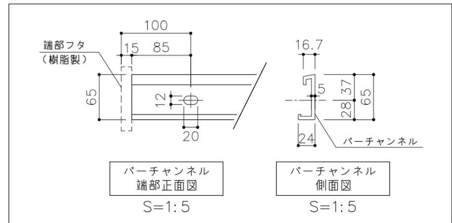
【押出成形セメント板】内部ナット止式
